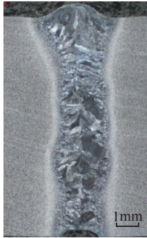
图3 焊缝截面形貌
